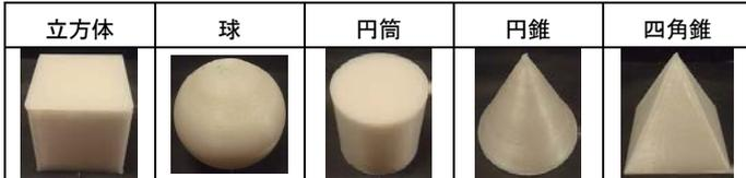
真を表2に示す。外装は3Dプリンター（3D Touch）を用いて作成し、中に粘土を入れることで重さの調節をした。また、重さは110gを基準として作成した。一般的に、人の重量感覚の弁別閾は2%だと言われている<sup>[3]</sup>。
